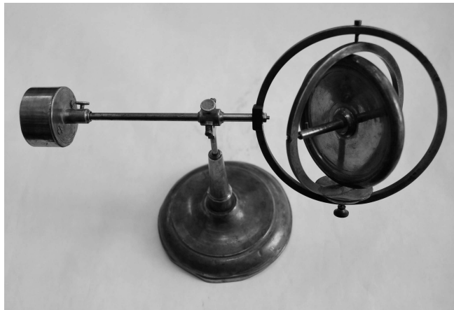
Figura 6.17: O fotografie a unui giroscop montat într-o suspensie cardanică.
