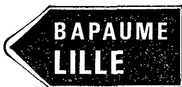
D 203 a Signalisation de position d'une sortie ou d'une bifurcation indiquant les directions autoroutières.
