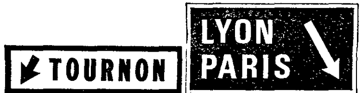
D 12 Signalisation avancée d'un carrefour routier important.
