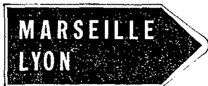
D 13 Jalonement vers une entrée d'autoroute.
